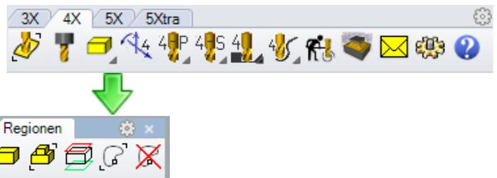
Nun klicken Sie in der Werkzeugleiste **4-Achsen Flächen Fräsen** auf **4-Achsen Z-Ebenen Schichten**. Auch hier haben wir Aufgrund der besseren Sichtbarkeit den Wert für die **Zustellung** auf 1 verändert.
