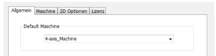
Auf dem nächsten Reiter **Maschine** können Sie eine voreingestellte Maschine wählen oder selbst eine neue Anlegen. Wir wählen hier die **4-axis\_Machine**. Diese besitzt eine A-Achse die um die X-Achse dreht.
